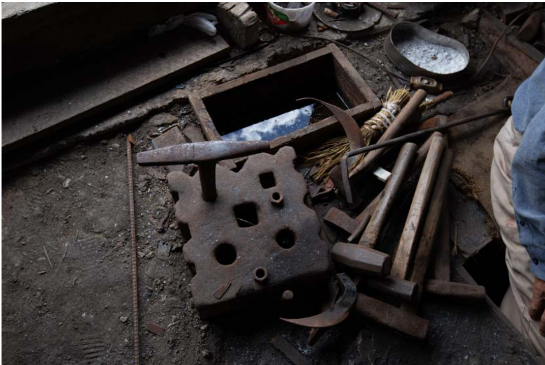
「巢床 スドコ」 自作の様々な道具を据える。現在据えてあるのは、金属をたたいて曲げるためのもの。 道具はすべて手作り。
