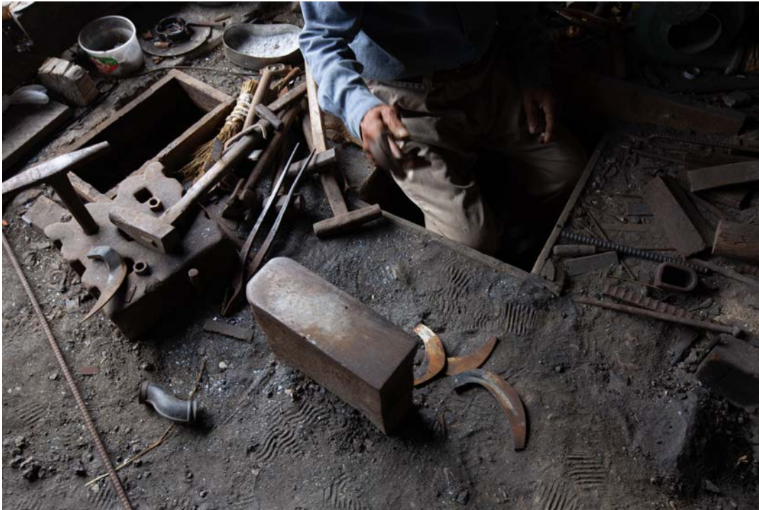
「金床 カナトコ」 熱した金属を叩く台。
