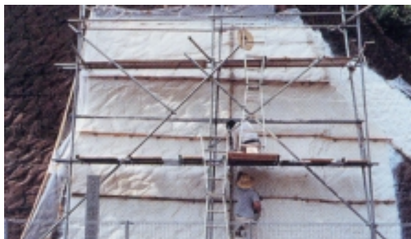
図2 漣痕の型取り。表面のほこりやコケを除去したのち、シリコンゴムを塗り重ねて型取りする。
