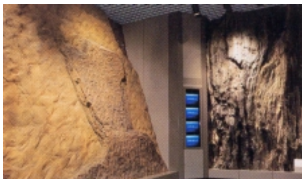
図3 レプリカの着色。工場に持ち帰ったシリコンゴム型にポリエステル樹脂を注入して成型し、実物に合わせて着色する。
